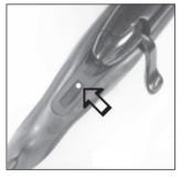
In dieser sicheren Stellung wird die Waffe geladen und entladen. Unbeabsichtigte Schussauslösung ist unmöglich.
