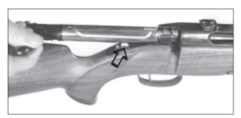
Verschluss am Kammergriff aus dem Gehäuse ziehen.
