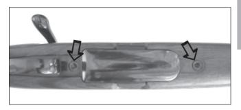
Werden diese Schrauben gelöst, müssen sie mit einem Drehmomentschlüssel (7 Nm) festgezogen werden.
