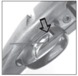
Dreht man die Schraube im Gegenuhrzeigersinn wird der Abzugswiderstand stärker.
