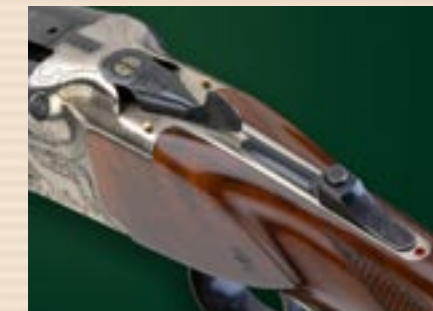
Dreistellungs-Schieber in mittlerer Rast: Die Schlosse der oberen Läufe sind gespannt und entsichert, das Schloss für den unteren Lauf ist entspannt.
