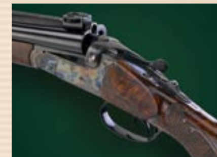
(Rechts) Büchsfinten-Waldläufer: schön und selten. Anson-Schlosse mit oben liegenden Stangen, separate Handspannung für den kleinen Kugellauf.
