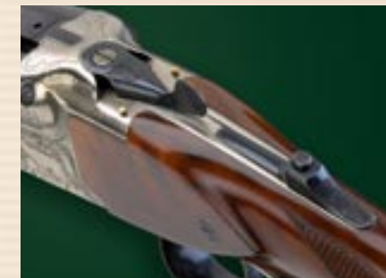
Dreistellungs-Schieber in hinterer Position: Die Schlosse der oberen Läufe sind gespannt und gesichert, das Schloss für den unteren Lauf ist entspannt.
