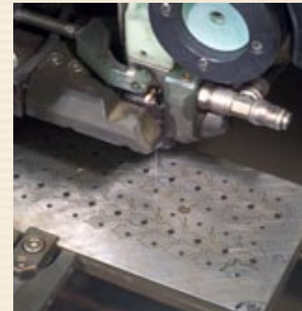
Die Erodieretechnik gestattet die präzise Serienfertigung kleiner Teile und komplexer Formen wie z.B. profilierte Öffnungen in Baskülen.
