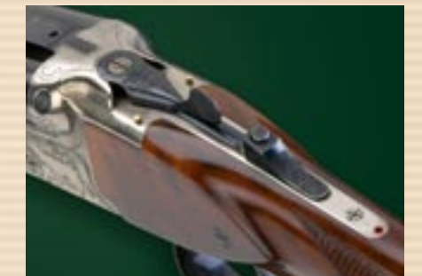
Dreistellungs-Schieber in vorderer Rast: Die Schlosse der oberen Läufe sind gespannt, der linke Lauf ist entsichert, der rechte Lauf gesichert, das Schloss für den unteren Lauf ist gespannt und schussbereit.
