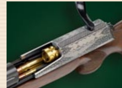
Der solide Drehkopfverschluss verriegelt über sechs Warzen im Lauf.
